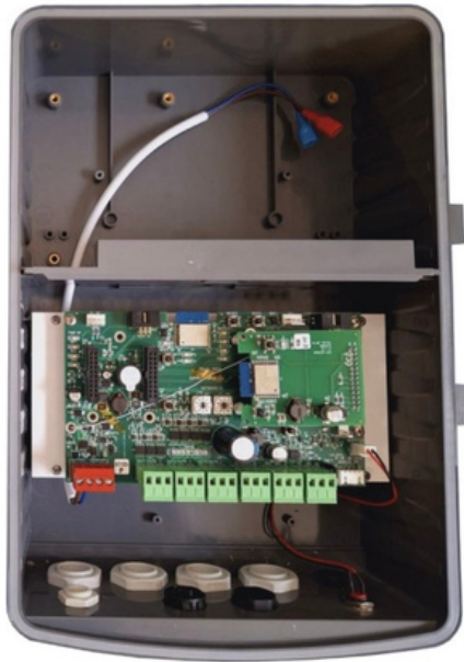
SAPIR 2 MINI DC - 6 OUT / 4 IN / 2 ANA IN + External Wi-Fi Modem
